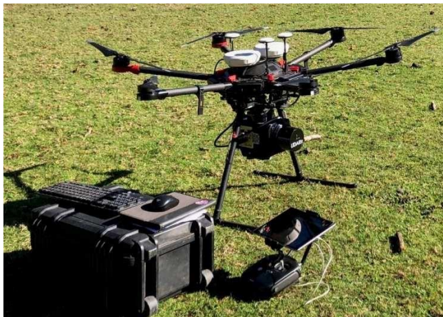
Drone Matrice 600 PRO más sensor LiDAR incorporado.
